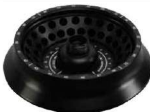
Rotor angulaire en aluminium Microliter 48 x 2, 45°, R max 98 mm
