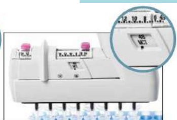
Fenêtre Equalizer réglée sur « 48 MCT » avec microplaques à 48 puits ou tubes MCT
