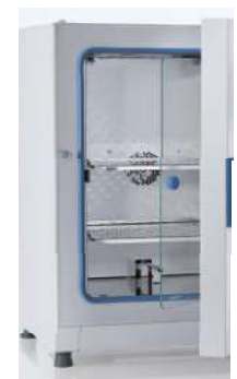
Incubateur microbiologique Thermo Scientific Heratherm Advanced Protocol avec système exclusif de convection double
