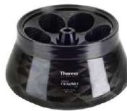
Rotor angulaire Fiberlite F14-6x250 LE, 23°, R max 137 mm
