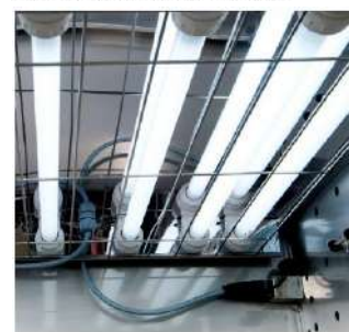
Intérieur de la chambre à lumière verticale Thermo Scientific avec modules de lumière pour incubation d'animaux installés.
