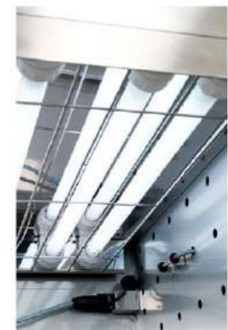
Intérieur de la chambre à lumière verticale Thermo Scientific avec modules de lumière pour incubation d'animaux installés.
