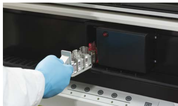
Lecteur codes-barres intégré permettant l'identification positive des réactifs en temps réel.
